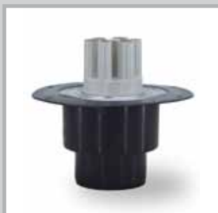
MFD 150/160 mit acht Stutzen und vier Thermo-Schrumpfmuffen Vier Stutzen sind im Lieferzustand geschlossen und können bei Bedarf durchbrochen werden. Geeignet für maximal vier Kabel mit Durchmesser 7–23 mm und maximal vier Kabel mit Durchmesser 7–33 mm. Als Zubehör sind verschiedene Aufteilkappen AK oder Verschluss-Stopfen VS 25 bzw. VS 35 lieferbar.
