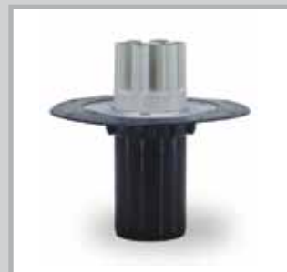
MFD 110/125 mit sieben Stutzen und sechs Thermo-Schrumpfmuffen Ein Stutzen ist im Lieferzustand geschlossen und kann bei Bedarf durchbrochen werden. Geeignet für maximal vier Kabel mit Durchmesser 7–23 mm und maximal drei Kabel mit Durchmesser 7–30 mm. Als Zubehör sind verschiedene Aufteilkappen AK oder Verschluss-Stopfen VS 25 bzw. VS 32 lieferbar.
