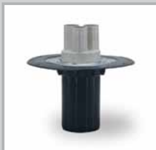
MFD 110/125 mit drei Stutzen und drei Thermo-Schrumpfmuffen Geeignet für drei Kabel mit Durchmesser 16–44 mm. Als Zubehör sind verschiedene Aufteilkappen AK oder Verschluss-Stopfen VS 46 lieferbar.
