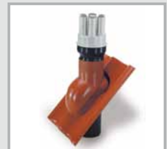
MSD 110 mit sieben Stutzen und sechs Thermo-Schrumpfmuffen Ein Stutzen ist im Lieferzustand geschlossen und kann bei Bedarf durchbrochen werden. Geeignet für maximal vier Kabel mit Durchmesser 7–23 mm und maximal drei Kabel mit Durchmesser 7–30 mm. Als Zubehör sind verschiedene Aufteilkappen AK oder Verschluss-Stopfen VS 25 bzw. VS 32 lieferbar.
