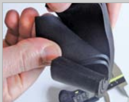
Entfernen der nicht benötigten Zwiebelringe
