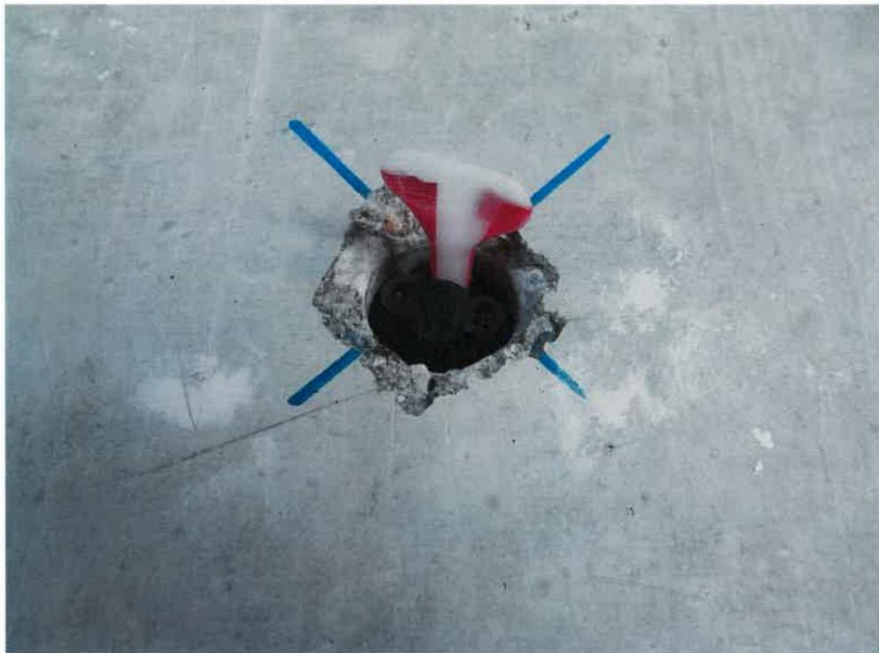
**Bild 5** montierte Gummipressdichtung mit Kunststoff-Vollstab  $\varnothing$  7 mm zur Prüfung der Gasdichtheit
