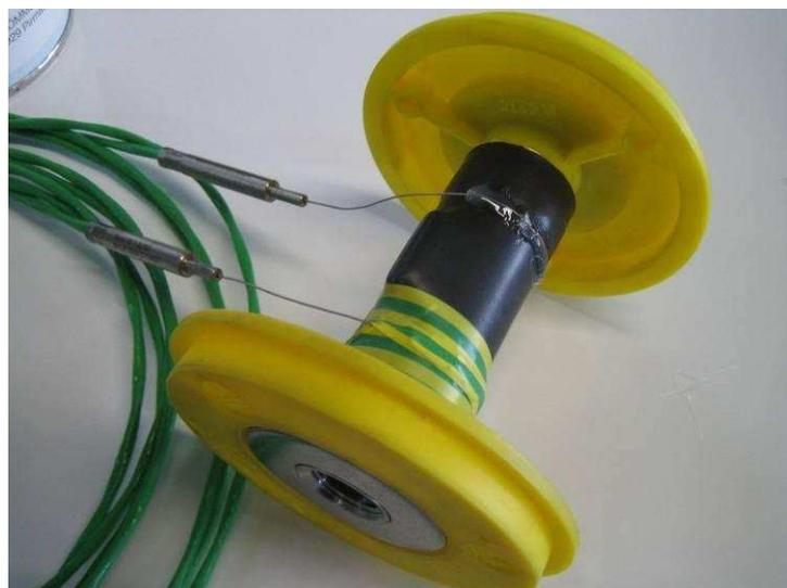
*Bild 2: Lage der Thermoelemente*
