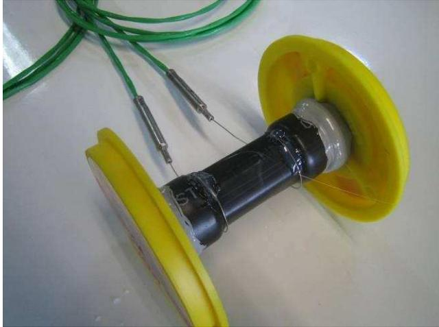
*Bild 1: Erdungsdurchführung mit Thermoelementen*
