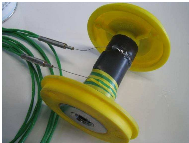
Bild 2: Lage der Thermoelemente
