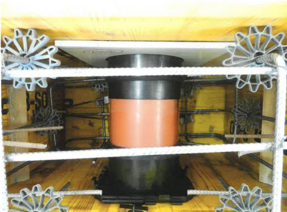
Bild 4: in der Prüfkörperschalung eingebaute Doppeldichtpackung
