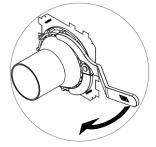
Die Mutter mittels UGA-Gelenk-Stirnloch-Schlüssel "GSS" festziehen, bis sich der Systemdeckel nicht mehr drehen lässt, und ein leichtes Weiterdrehen der Mutter nicht mehr möglich ist.
