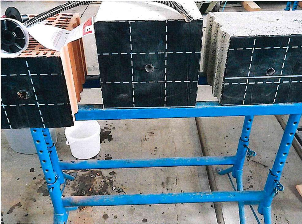
Bild 7 Probekörper mit KSK nach Herstellung der Bohrlöcher
