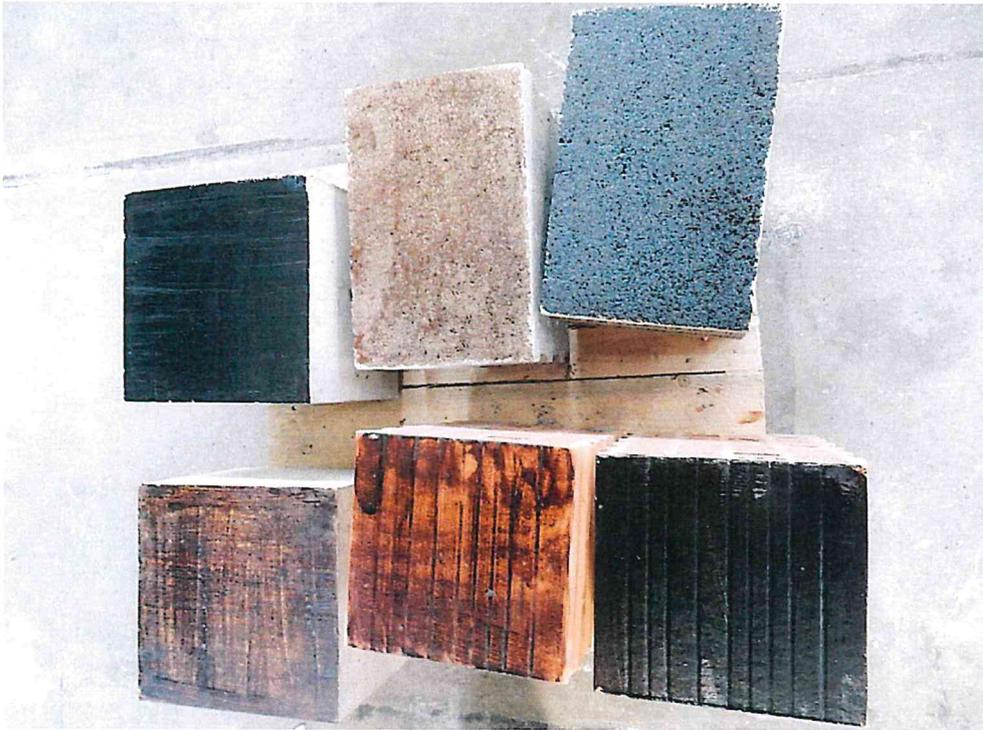
Bild 1 Probekörper mit aufgetragener Grundierung
