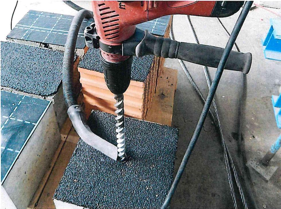
Bild 5 Herstellen der Bohrungen
