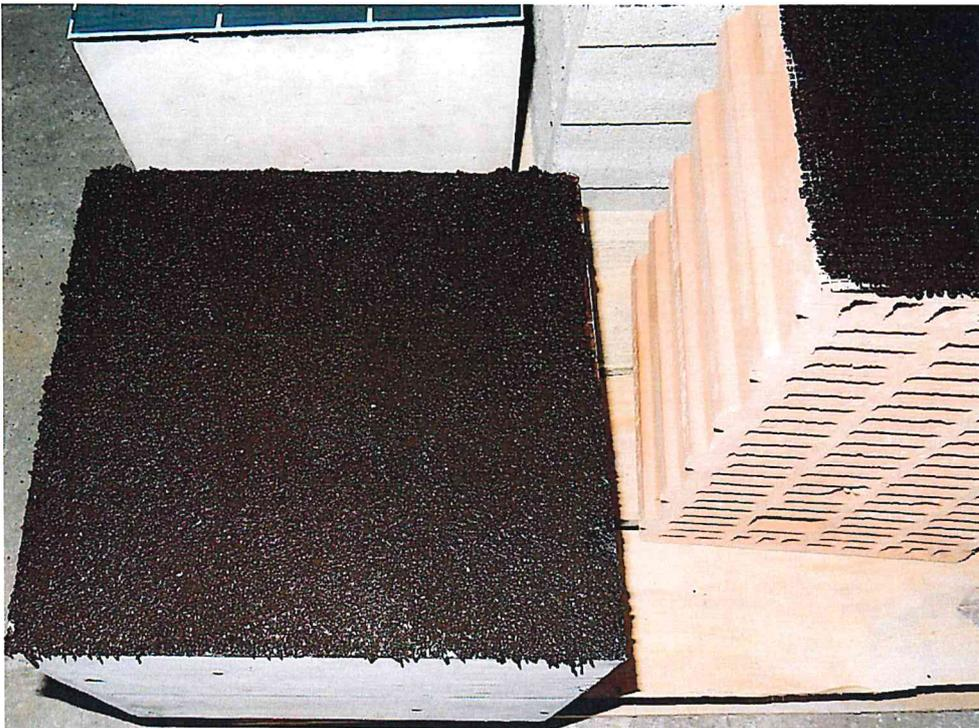
Bild 4 WU-Probekörper mit *Sopro KD 752 KellerDicht 1-K*
