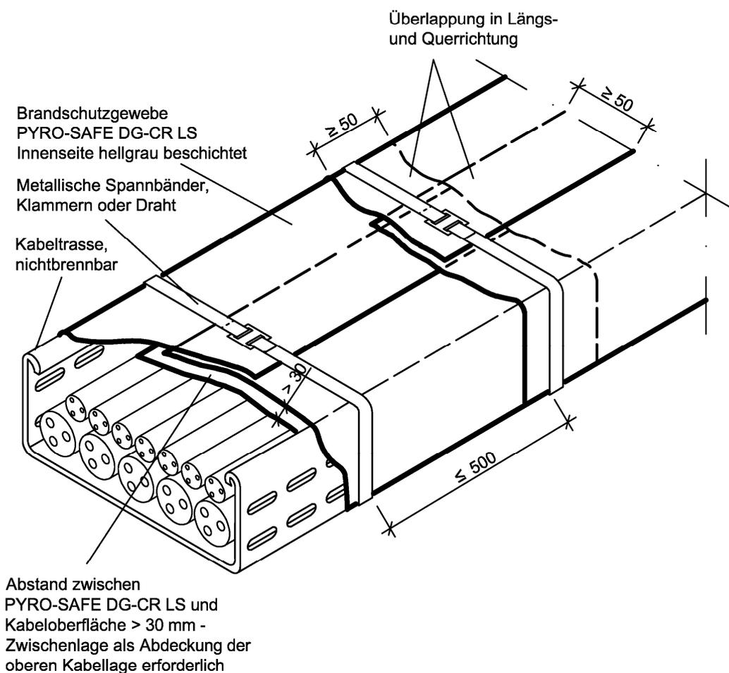
**Umhüllungen von elektrischen Leitungen und Leitungsanlagen mit dem Brandschutzgewebe "PYRO-SAFE DG-CR LS"**
