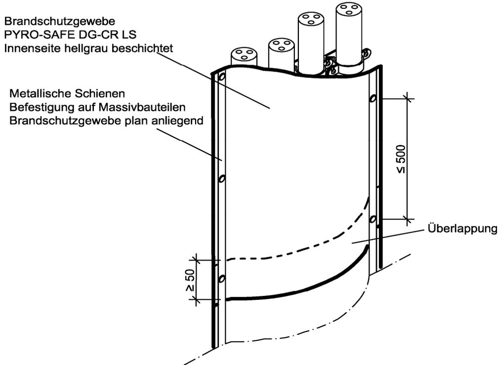
**Ausführung von Kabelein- bzw. Ausgängen bei Anwendungen gemäß Abschnitt 1.2.1.b)**
