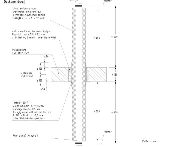
Feuerwiderstandsfähige Abschottung für Rohrleitungen aus Kunststoff "Curaflam System Rollit ISO Pro-VB" bzw. "System FS-T VB" bzw. "System FSW-VB"
